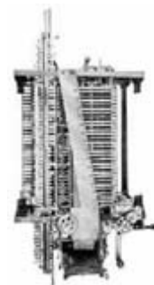
แอนาไลติคอลเอนจินที่พัฒนา มาจากดิฟเฟอเรนซ์เอนจิน
