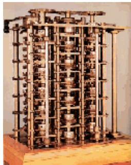
ดิฟเฟอเรนซ์เอนจิน ที่คิดค้นโดยชาร์ลส์ แบบเบจ
